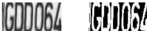
Figura 7. Error en la normalización del color del fondo del candidato. a) Matrícula en escala de grises. b) Normalización errónea del color del fondo de la matrícula.
